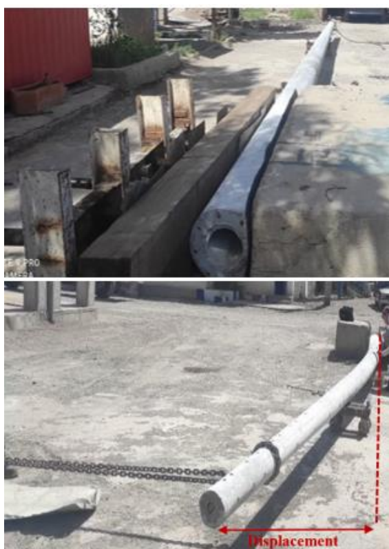
شکل ۱ مقاله: شرایط تست آزمایشگاهی برای در نظر گرفتن مقاومت
