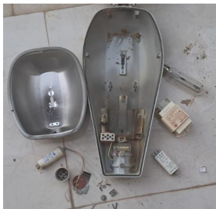
شکل ۱ مقاله: چراغ خیابانی بخار سدیم پیش از بازطراحی و تجهیزات داخلی جداسازی شده
