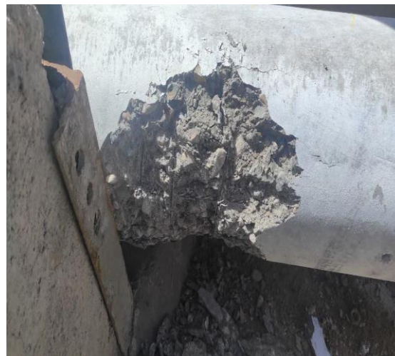
شکل ۵ مقاله: پایه مردود شده پس از گذر از مقاومت نهایی
